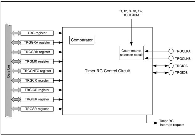
Figure 23.1 Timer RG Block Diagram
